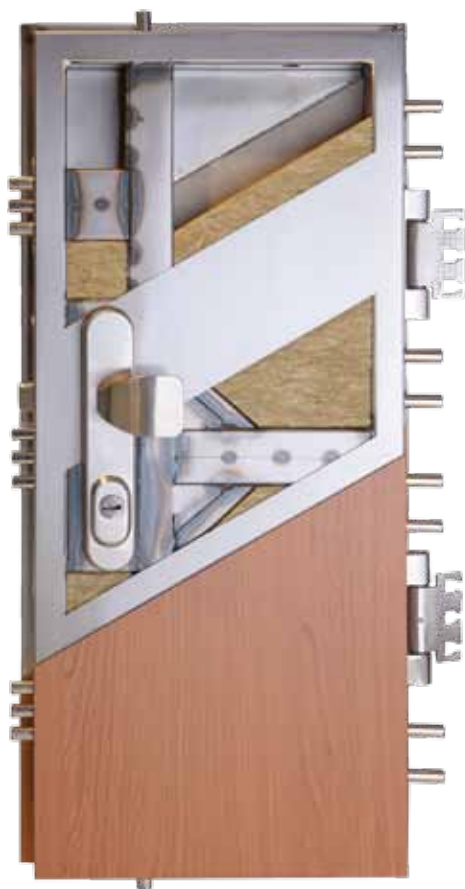
Řez dveří ŘADA ELITE II.
